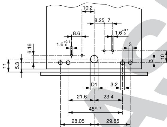
Befestigung von unten auf Print oder Gehäuseboden
