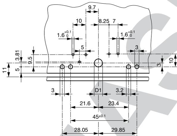
D1 = 6.2 mm Befestigung von oben / D1 = 3.6 mm Befestigung von unten Leiterplatte max. 1.6 mm / Nicht tolerierte Masse: ≤ 15 = ± 0.05 / > 15 = ± 0.10
